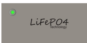
Teilansicht Power Controller mit Ladeanzeige für die Batterieladung
